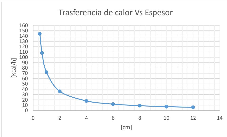
Gráfica 1: Comportamiento del calor en función al espesor de madera del troje "A"
